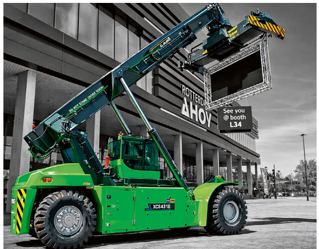
Der Vollcontainer-Reachstacker XCS4531E von XCMG wird vollelektrisch betrieben.
