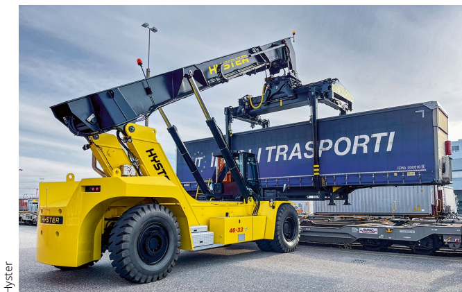
Ein Hyster RS46 mit Intermodal-Spreader bewegt einen Container.
