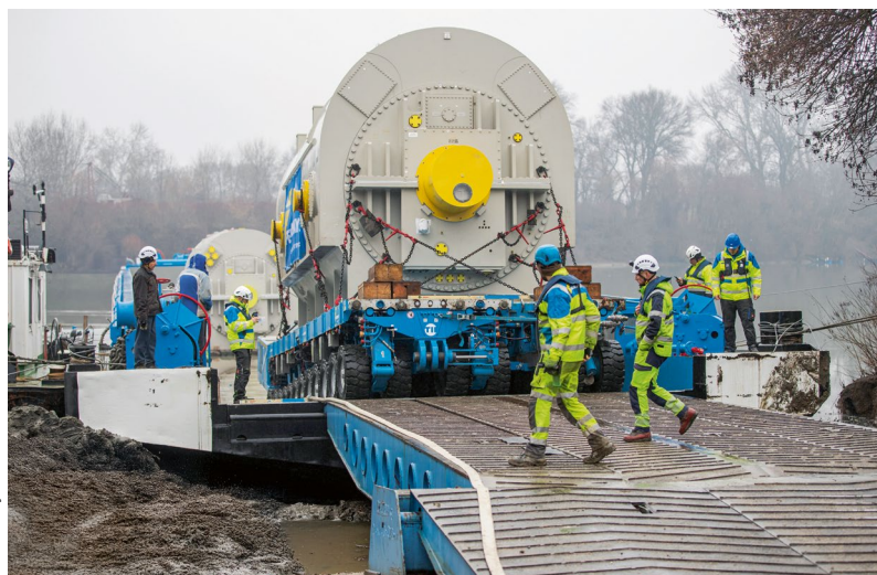
Über die RoRo-Rampe rollte der SPMT mit dem Generator aus dem Schiff aus und fuhr direkt weiter durch die Stadt Mako bis zum Umladeplatz.
