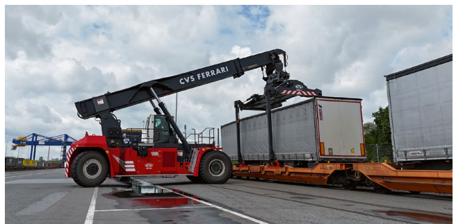
Das Modell hat eine Tragkraft von bis zu 45 Tonnen.
