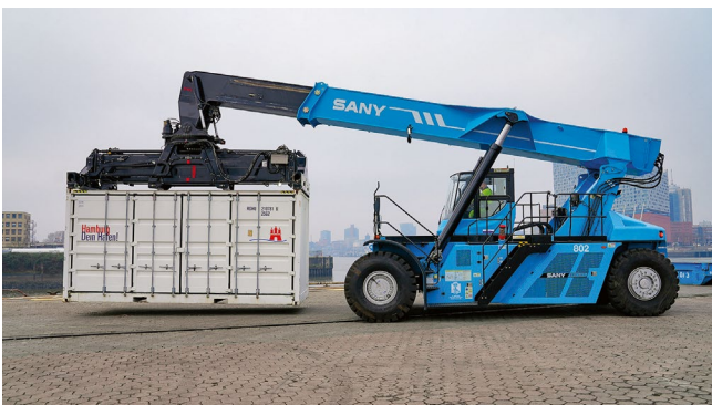
Zwecks CO 2 -neutraler Umschlagprozesse integriert die Firma C. Steinweg einen vollelektrischen Reachstacker.
