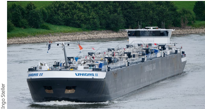
Der Flüssiggastanker UNIGAS 2 ist mit 135 x 11,45 Metern der aktuell längste Typ (Ausbau: Breko).
