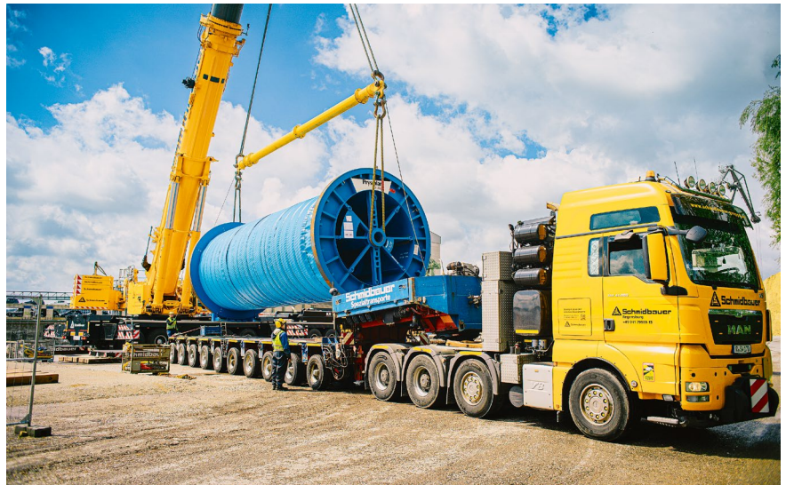
10 Meter lang, 80 Tonnen schwer: Verladung von Kabeltrommeln für die Energiewende durch Schmidbauer
