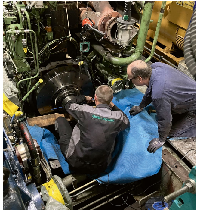
Kupplungstausch am großen Motor eines Seeschiffes
