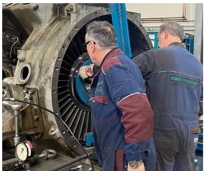
MWB-Power-Mitarbeiter bearbeiten einen 22-Megawatt-Motor. Im Bild die Demontage einer Ölstromkupplung.
