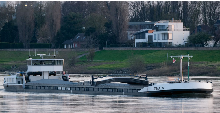
„ELAN“ ist ein Leichtbau-Güterschiff von 110 x 11,45 m von der GS Yard.
