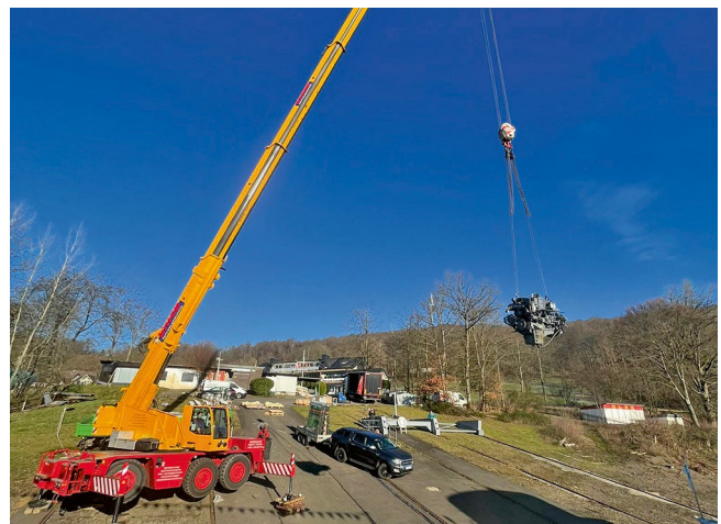
Während der Elektrifizierung des EMS „Westfalen“ musste viel schweres Gerät bewegt werden, hier der Aushub eines alten Dieselmotors.
