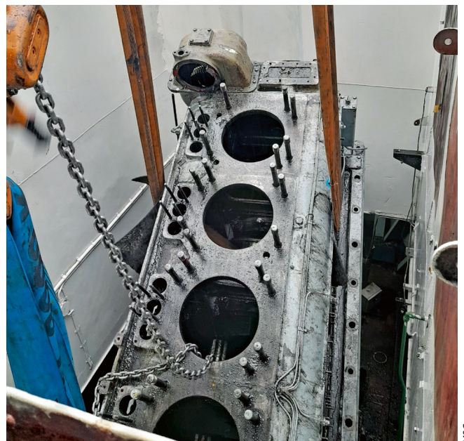
Aushub des alten Motorblocks aus dem GMS „Rhönland“.
