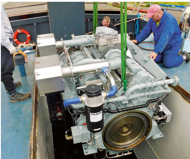
Einbringen des neuen Motors in das GMS „Malo“.
