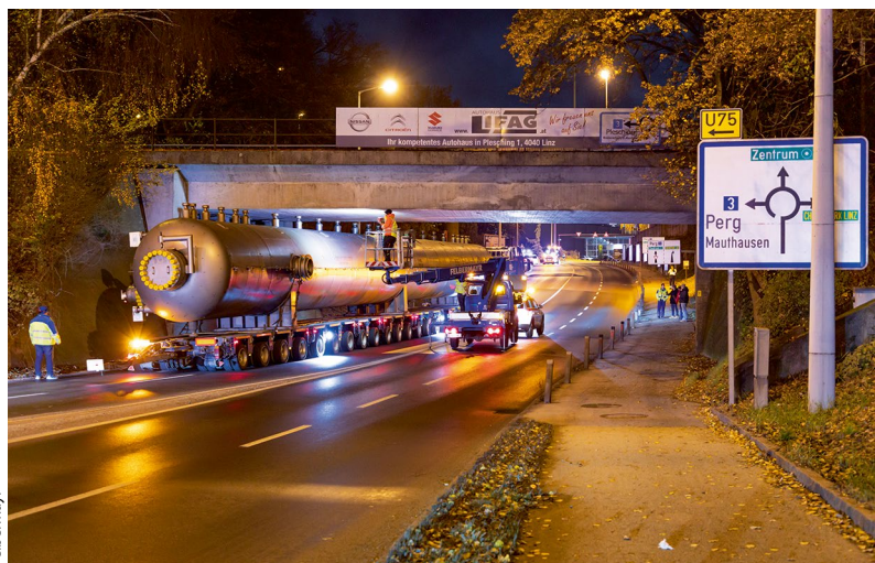
Millimeterarbeit beim Unterfahren einer 4,66 Meter hohen Eisenbahnbrücke.
