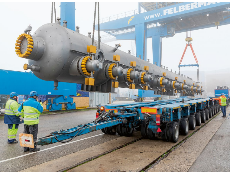
Mittels zweier Portalkräne wurden die 180 Tonnen schweren Großkomponenten auf die Tieflader umgeschlagen.
