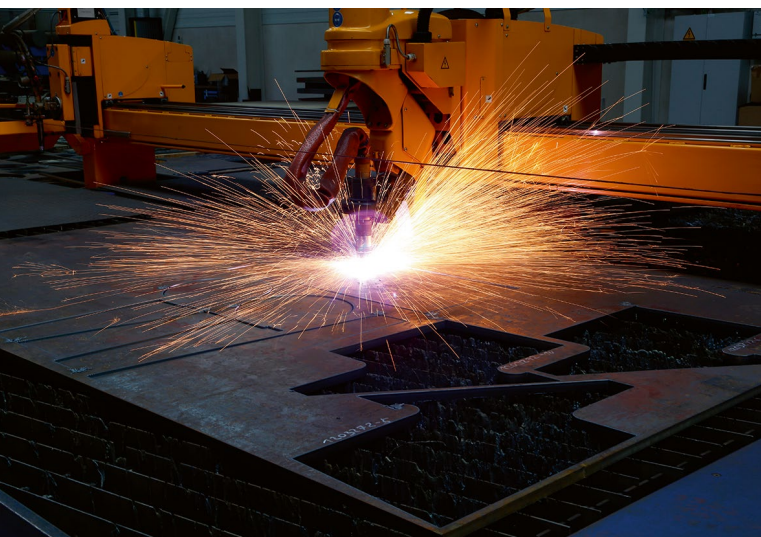
Ein Blick auf einen thermischen Zuschchnitt: Vor Ort in Dörth wird SUT Teil von vielen praxisnahen Arbeitsprozessen aus nächster Nähe.
