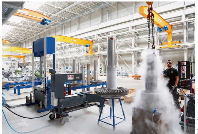
Beim thermischen Schrumpfen werden Welle und Tellerrad mittels verschiedener Temperierungen ineinandergefügt.
