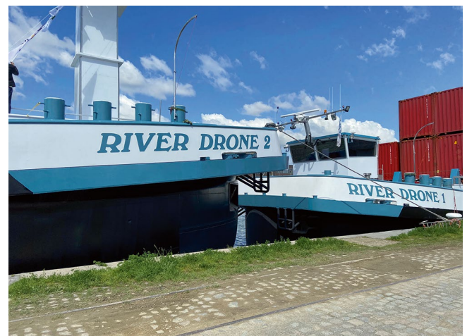
Die von Naval gecharterten Riverdrones verfügen nur noch über einen rudimentären Fahrstand, gesteuert werden sie von Seafar in Antwerpen.
