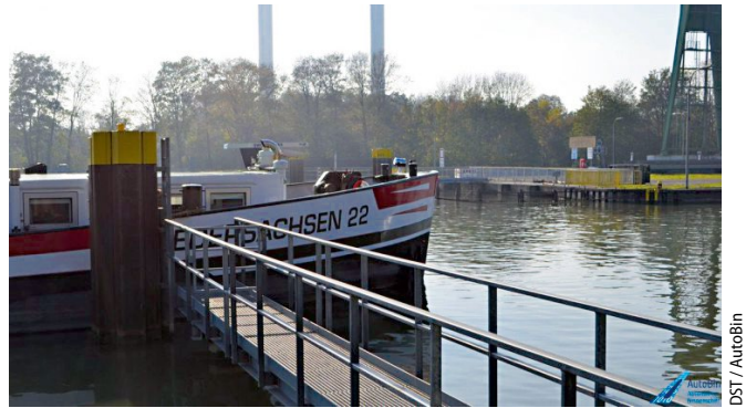
Die „Niedersachsen 22“ diente als Testschiff des Verbundprojekts AutoBin. Ziel ist das automatisierte Fahren in der Binnenschiffahrt.
